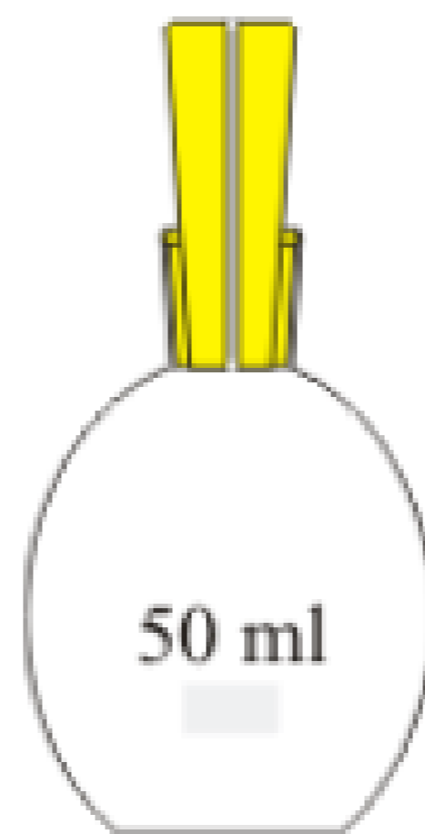
Slika 1. Piknometar za određivanje gustoće tekućina.
