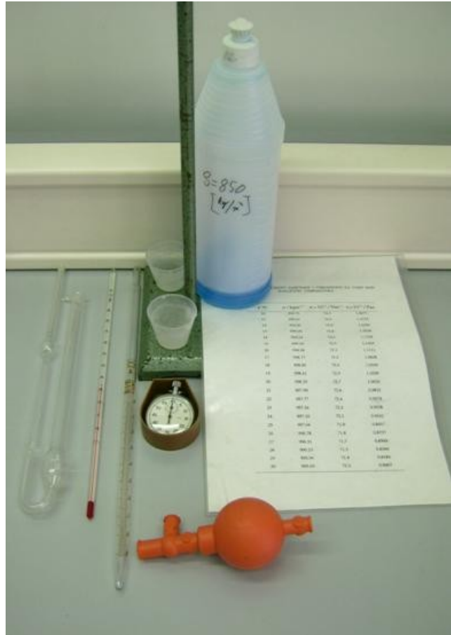
Slika 3 Pribor potreban za izvođenje vježbe: Ostwaldov viskozimetar, termometar, pipeta, gumena pumpa za pipetu (propipeta), zaporna ura, 2 čaše, stalak sa držačem, voda, zadana tekućina, tablica sa vrijednostima gustoće i viskoznosti vode pri različitim temperaturama.
