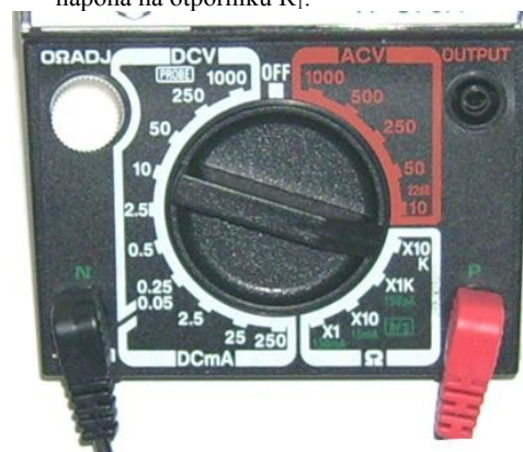
Slika 10. Rotacioni prekidač na multimetru, služi za izbor fizikalne veličine koja se mjeri i mjerne skale prema kojoj valja očitati mjerenje.
