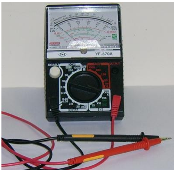
Slika 7. Analogni multimeter je uređaj koji služi za mjerenje jakosti struje ili pada napona u strujnom krugu, ovisno kako je spojen u strujni krug. Uređaj se sastoji od mjerne skale, kružnog prekidača i mjernih sondi.
