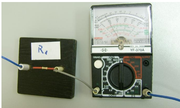
Slika 9. Analogni multimeter spojen serijski s otpornikom R_1 . Ovako spojen uređaj mjeri jakost struje koja prolazi otpornikom.
