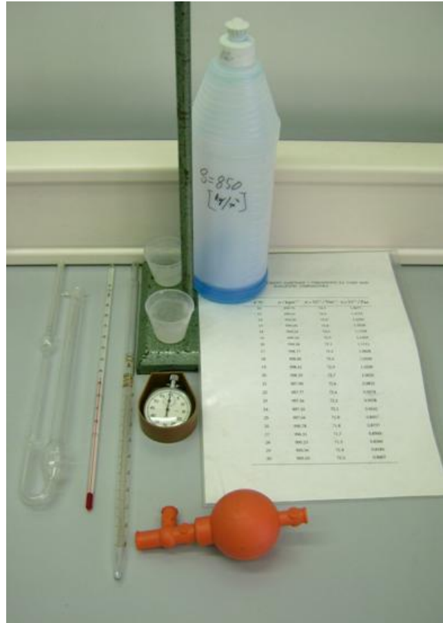
Slika 3 Pribor dostupan za izvođenje vježbe: Ostwaldov viskozimetar, termometar, pipeta, gumena pumpa za pipetu (propipeta), zaporna ura, 2 čaše, stalak sa držačem, destilirana voda, zadana tekućina, tablica sa vrijednostima gustoće i viskoznosti destilirane vode pri različitim temperaturama.
