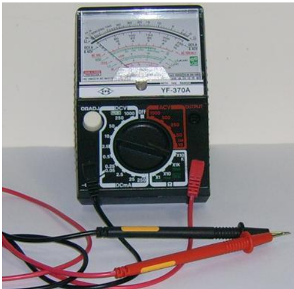
Slika 3. Analogni multimetar je uređaj koji služi za mjerenje jakosti struje ili pada napona u strujnom krugu, ovisno kako je spojen u strujni krug. Uređaj se sastoji od mjerne skale, kružnog prekidača i mjernih sondi.
