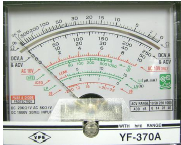
Slika 7. Mjerna skala analognog multimetra.
