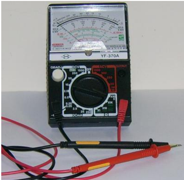
Slika 7. Analogni multimetar je uređaj koji služi za mjerenje jakosti struje ili pada napona u strujnom krugu, ovisno kako je spojen u strujni krug. Uređaj se sastoji od mjerne skale, kružnog prekidača i mjernih sondi.
