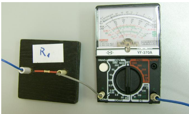
Slika 9. Analogni multimetar spojen serijski s otpornikom R_1 .
