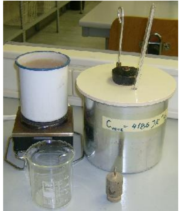
Slika 1 Pribor potreban za izvođenje mjerenja: kuhalo, izvor električne energije, posuda za zagrijavanje vode, čaša, voda, kalorimetar, termometar, vaga, tijelo poznatog specifičnog toplinskog kapaciteta i tijelo nepoznatog specifičnog toplinskog kapaciteta.
