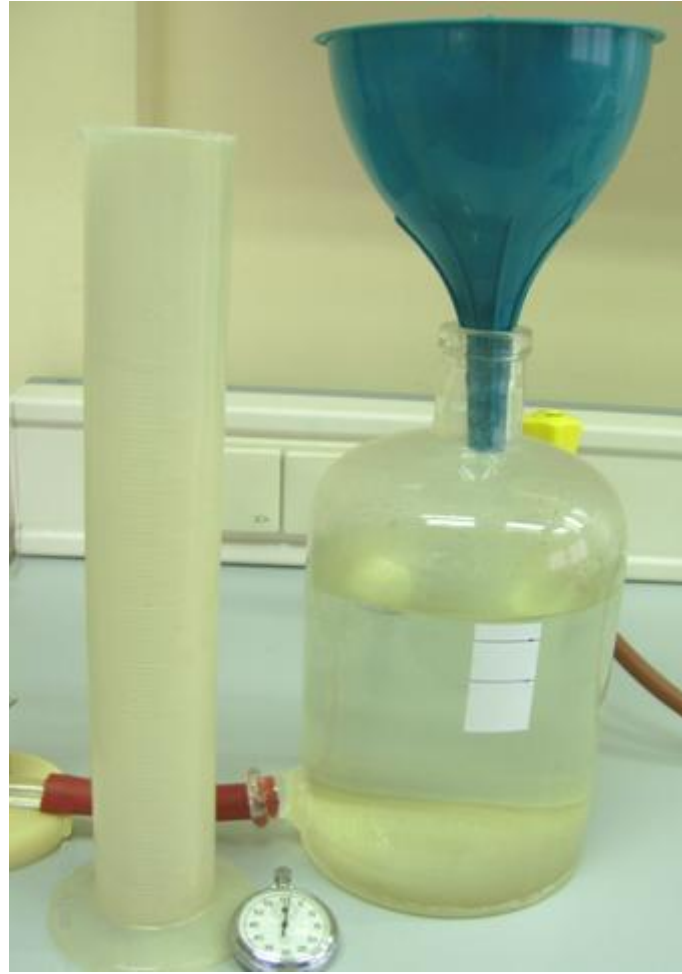
Slika 2. Pribor potreban za izvođenje mjerenja u drugom zadatku: posuda za vodu, lijevak, zaporni sat, menzura, cijevi, slavina.
