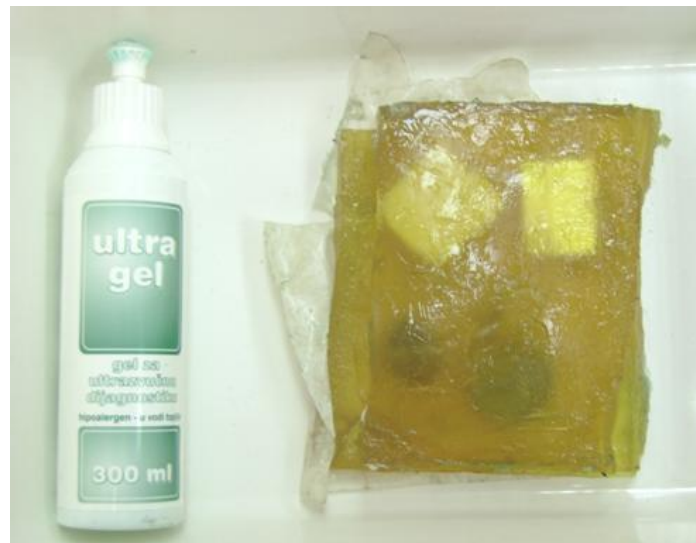
Slika 5 Kontaktni gel i bolus na kojem se izvode mjerenja.
