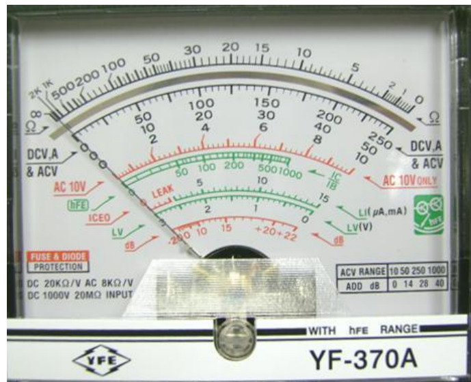
Slika 11. Mjerna skala analognog multimetra.
