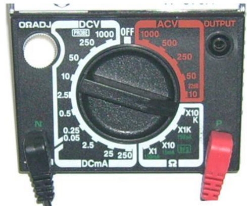
Slika 10. Rotacioni prekidač na multimetru, služi za izbor fizikalne veličine koja se mjeri i mjerne skale prema kojoj valja očitati mjerenje.
