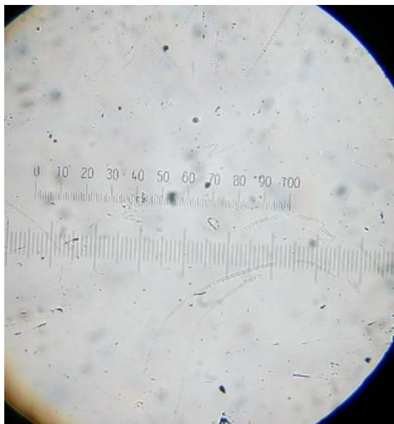
Slika 6. Okularna skala na srednjem povećanju. Skala koja ima naznačene brojeve je okularna skala, okularni mikrometar, nalazi se u okularu mikroskopa. Skala bez brojeva je objektni mikrometar, nalazi se na predmetnom stakalcu.
