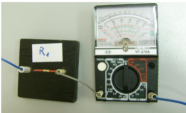
Slika 9. Analogni multimetar spojen serijski s otpornikom R_1 . Ovako spojen uređaj mjeri jakost struje koja prolazi otpornikom.
